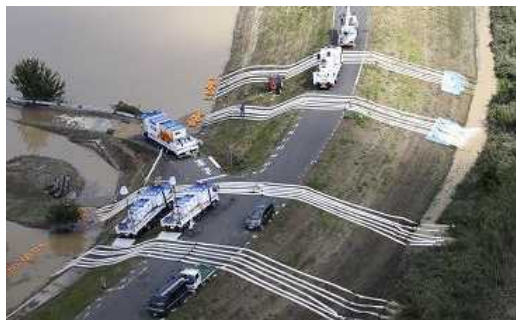
排水ポンプ車による排水作業【平成27年9月関東・東北豪雨】
